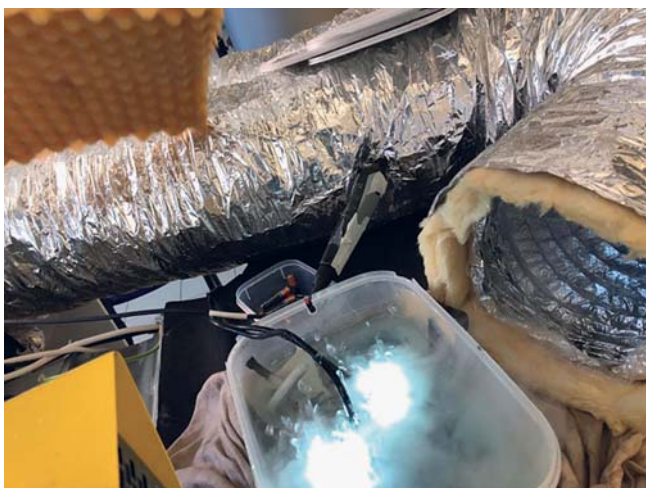
3. ábra. Az elszívott levegő légállapotának biztosítása
