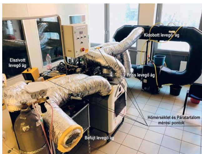
1. ábra. A HVM kísérleti mérőállás a vizsgált berendezéssel
